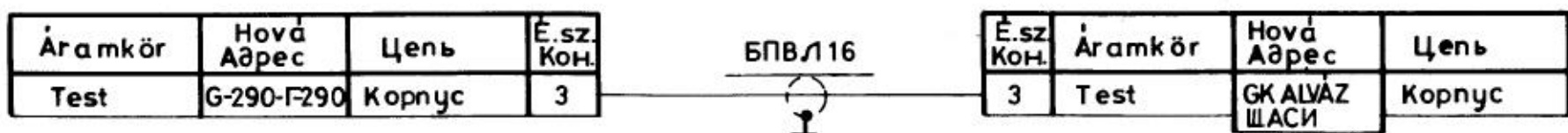
86. ábra 68 sz. 44-853-006 rsz.-ű kábel bekötési vázlat ( G-290 - GK-ALVÁZ )
