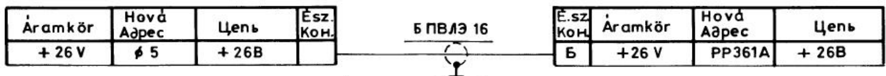
87. ábra 69 sz. 44-853-121 rsz.-ű kábel bekötési vázlat ( φ 5 - PP-361A )
