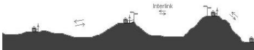
15.1-2. ábra. Két állomás kapcsolata átjátszókon keresztül
